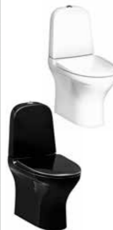
Estetic 8300 med skjult S/P-lås, u/skruehull, for liming. Klosett med åpen spylekant, 2/4 ltr, C+
